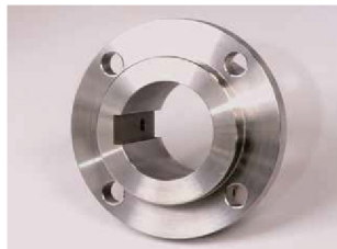
不锈钢40mm厚 Φ0.20 黄铜丝 2次加工 键槽加工 形状精度 ±5.0 μm 加工速度 比以往提高13%
